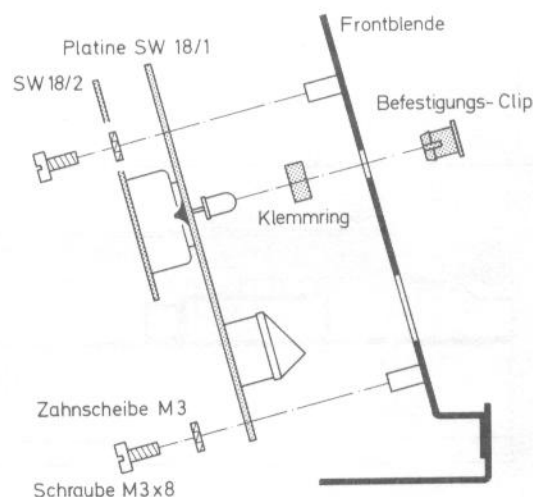
Abb.39 Einbau der Platine SW18 und Clip für LED
