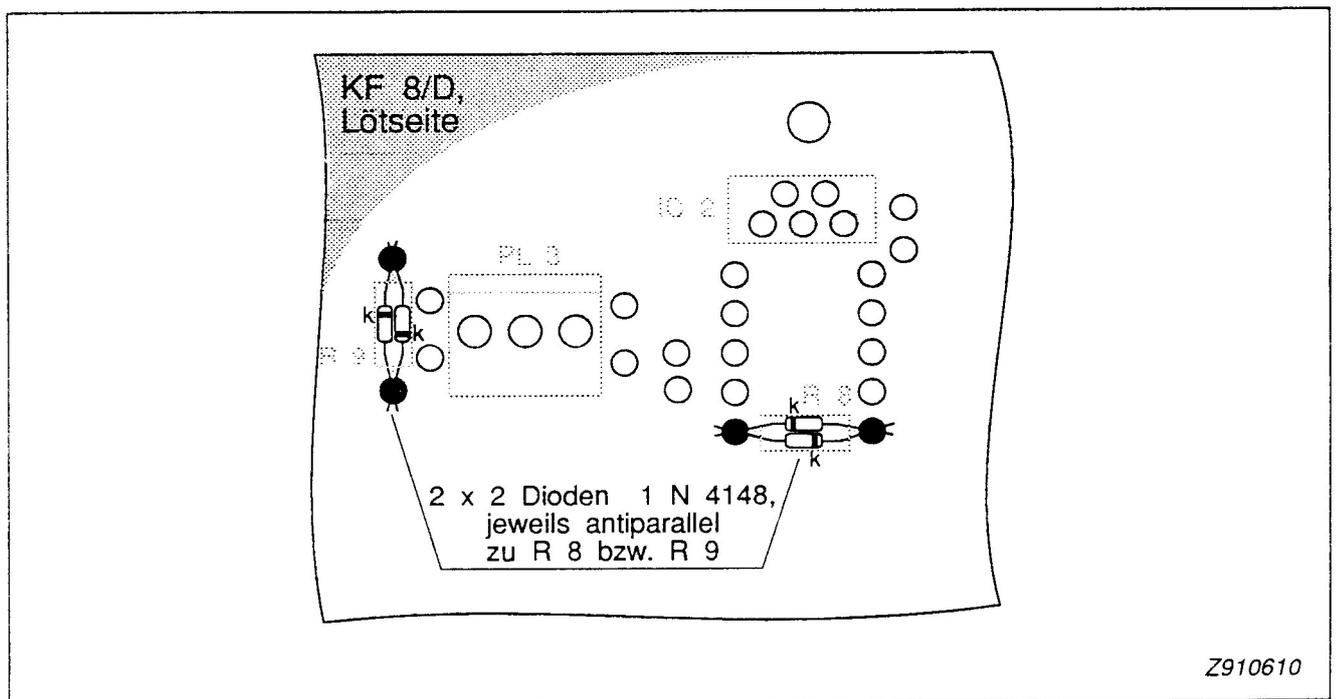
Zusätzliche Dioden auf der Lötseite der Platine KF 8
