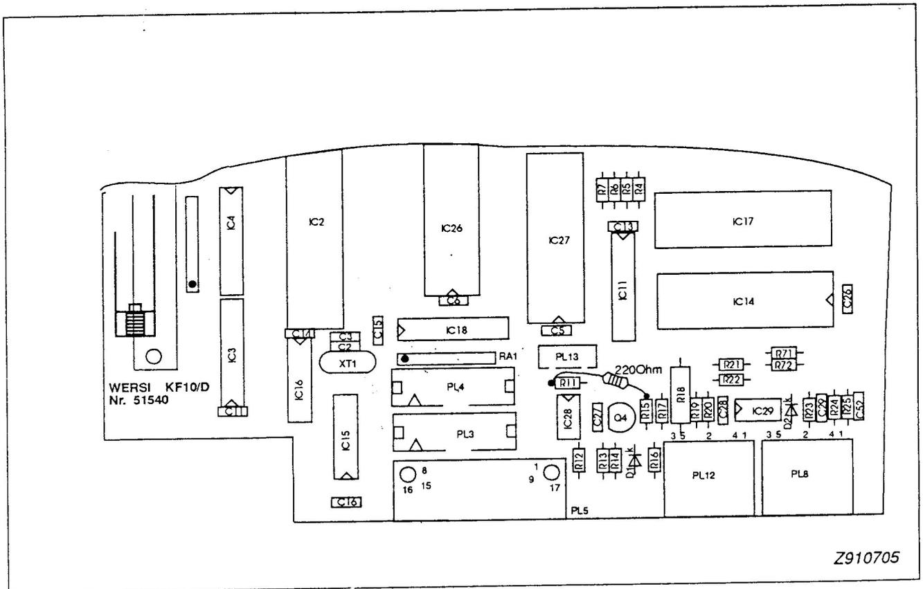
Zusätzlicher 220 Ohm-Widerstand auf der Platine KF 10
