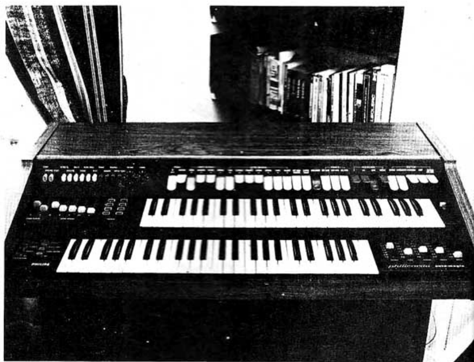
↑ Cette vue générale des claviers et des organes de commande montre l'accessibilité de ces derniers. Le temps de transit d'une main vers ces commandes est en effet un handicap au cours d'un même morceau et la disposition judicieuse et fonctionnelle de celles-ci est très importante.
