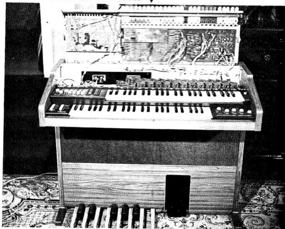
↓ La majorité des circuits électroniques se trouve réunie sous la face supérieure qui est très facilement démontable et montée sur charnière. On pourra remarquer que le nombre d'heures de câblage nécessaire à la réalisation de cet orgue doit être assez important. A gauche, la platine imprimée de la boîte de rythmes ; à droite, les différents filtres et circuits d'effets spéciaux qui déterminent le timbre de la sonorité choisie.
