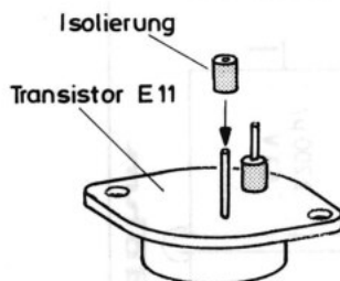
Bild 3. Isolierung der Transistoranschlüsse
