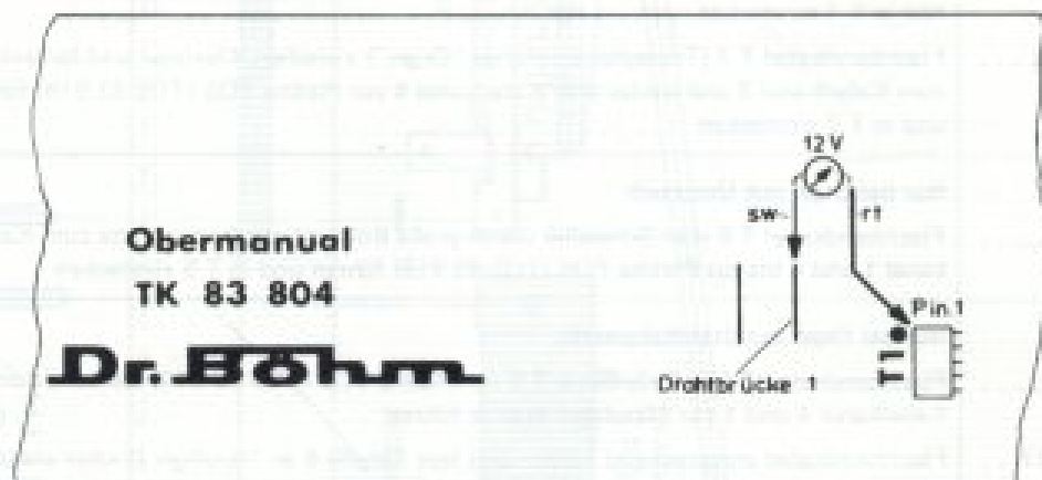
Bild G 14. Spannungsmessung Platine TK 83 804
