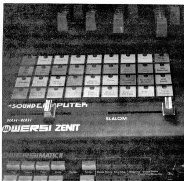
Abb. 1: Blick auf das obere linke Bedienfeld der ZENIT mit den Programmtasten
