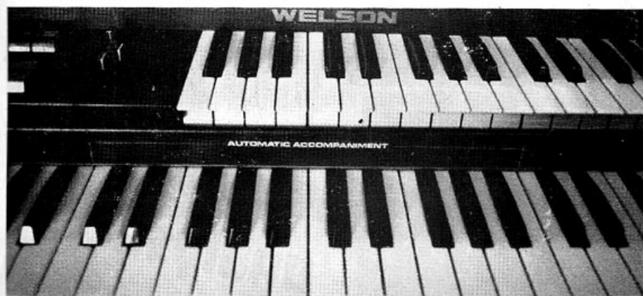
Les touches correspondant à l'accompagnement automatique sont délimitées par l'inscription située entre les deux claviers.
